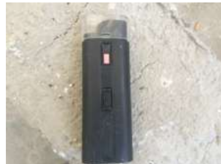
الشكل (3) مسطرة التشققات ومكبر لقياس عرض الشقوق
