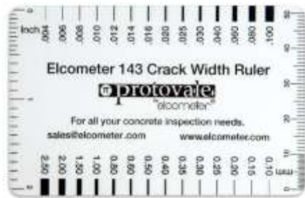
الشكل (3) مسطرة التشققات ومكبر لقياس عرض الشقوق
